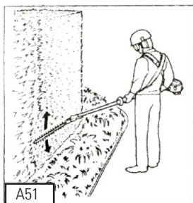
Coupe verticale Coupe en cas de position éloignée de la haie, par ex. en présence d'un parterre de fleurs entre l'utilisateur et la haie A 51.
